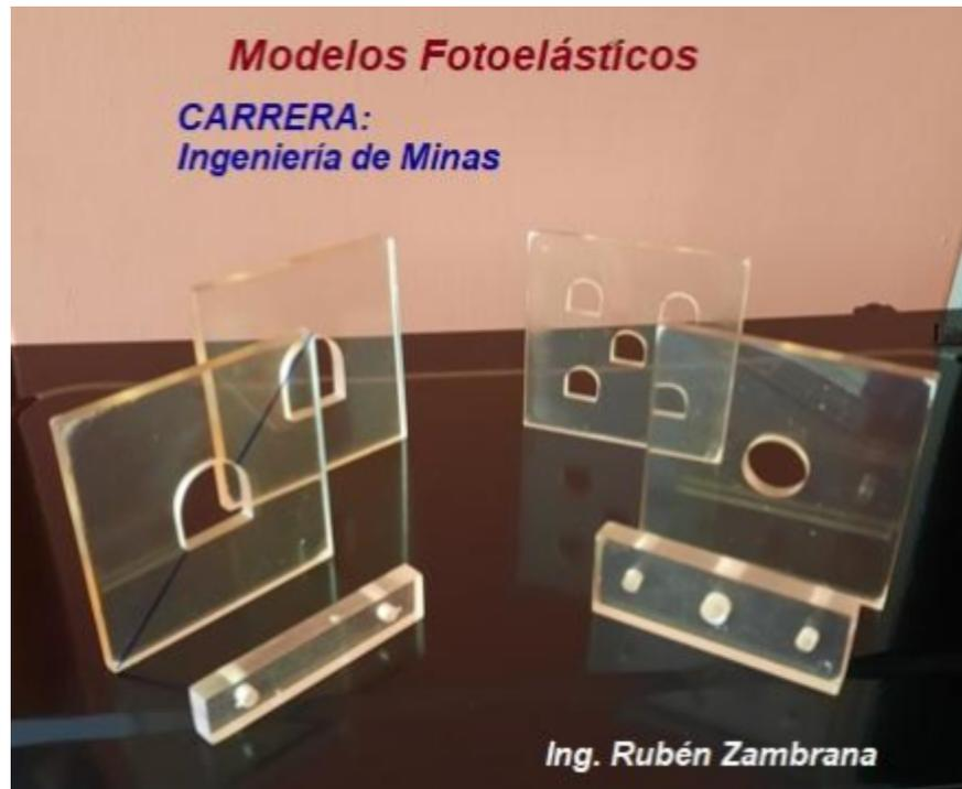
Figura 1 Modelos de resina fabricados y utilizados en la Investigación
