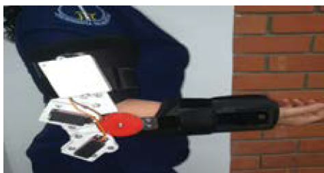
Figura 1: Impresión 3D del exoesqueleto Fuente: (Andrés Díaz, 2020)
