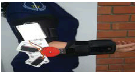
Figura 1: Impresión 3D del exoesqueleto Fuente: (Andrés Díaz, 2020)
