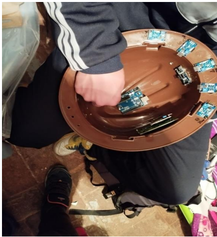
Figura 8: Ensamblaje al casco de los diferentes sensores
