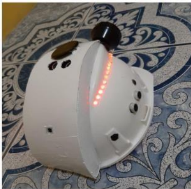
Figura 24: Casco inteligente para seguridad industrial desarrollado por UTE de Quevedo
